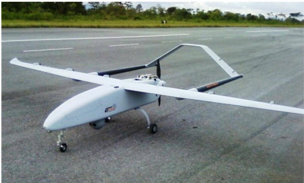
ภาพที่ 16 อากาศยานไร้คนขับรุ่น Tiger Shark II
