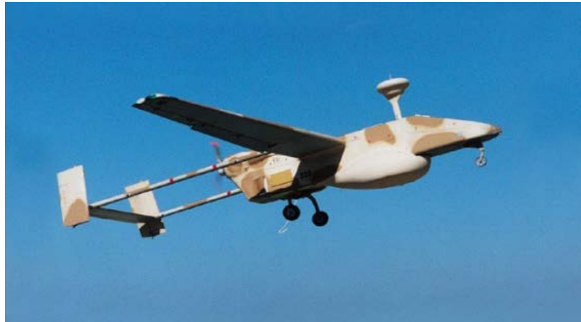
ภาพที่ 9 อากาศยานไร้คนขับรุ่น Searcher MK I
