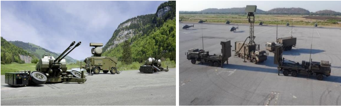
รูปที่ 9 – 10 ปตอ.35 มม. ควบคุมการยิงด้วยเรดาร์ และระบบอาวุธนำวิถี VL MICA
