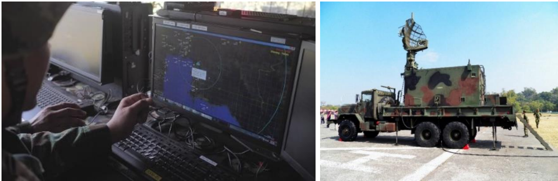
รูปที่ 15 – 16 ระบบ Sky Defender และเรดาร์แจ้งเตือนภัยระดับต่ำ LAADS
