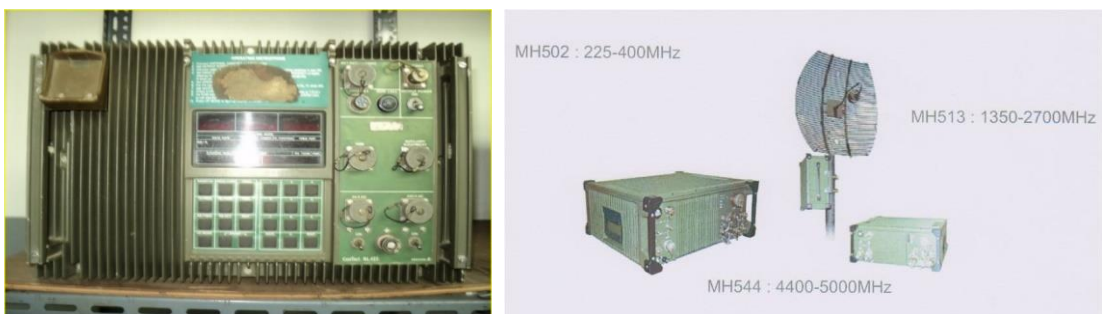
รูปที่ 17 – 18 ชุดวิทยุถ่ายทอด RL-422A (เก่า) และระบบวิทยุถ่ายทอดสนาม MH544 (ใหม่)
