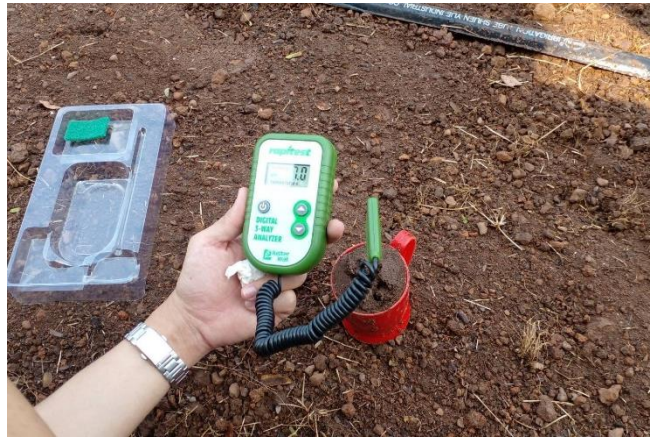
รูปที่ 1.12 การวัด pH ในดินก่อนใส่ถ่านชีวภาพ
