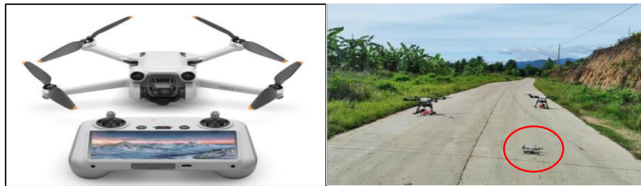
ภาพที่ 2 อากาศยานไร้คนขับ (โดรน) ยี่ห้อ DJI MINI 3 PRO บินได้นาน 34 นาที ระยะการบินไกล 4-5 กิโลเมตร ความคมชัด 48 ล้านพิกเซล
