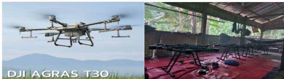
ภาพที่ 3 อากาศยานไร้คนขับ(โดรน)ยี่ห้อ DJI รุ่น AGRAS T30 ขนาดถัง 30 ลิตร มี 6 ใบพัด ขนาด 38 นิ้ว แบตเตอรี่ขนาด 29,000 MAH
