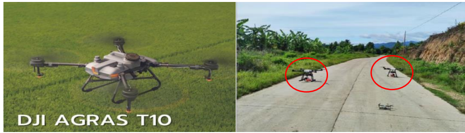
ภาพที่ 1 อากาศยานไร้คนขับ(โดรน)ยี่ห้อ DJI รุ่น AGRAS T10 ขนาดถัง 10 ลิตร มี 4 ใบพัด ขนาด 33 นิ้ว แบตเตอรี่ขนาด 9,500 MAH
