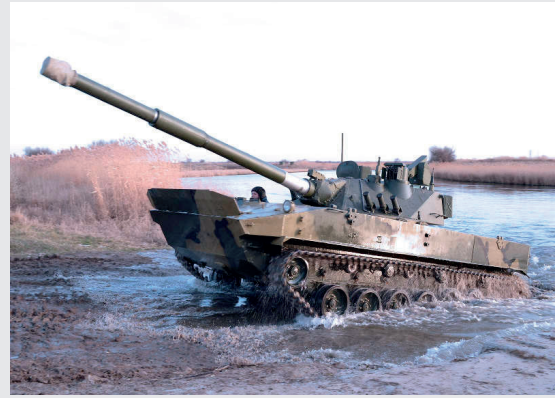
ภาพที่ 16 Sprut-SDM1 รถถังสะเทินน้ำสะเทินบก เทียบเท่ารถถังหลัก และติดตั้งปืนใหญ่ขนาด 125 มม.
