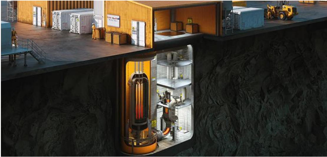
ภาพที่ 9 เตาปฏิกรณ์ผลิตไฟฟ้าพลังงานนิวเคลียร์ขนาดเล็ก (MMR)
