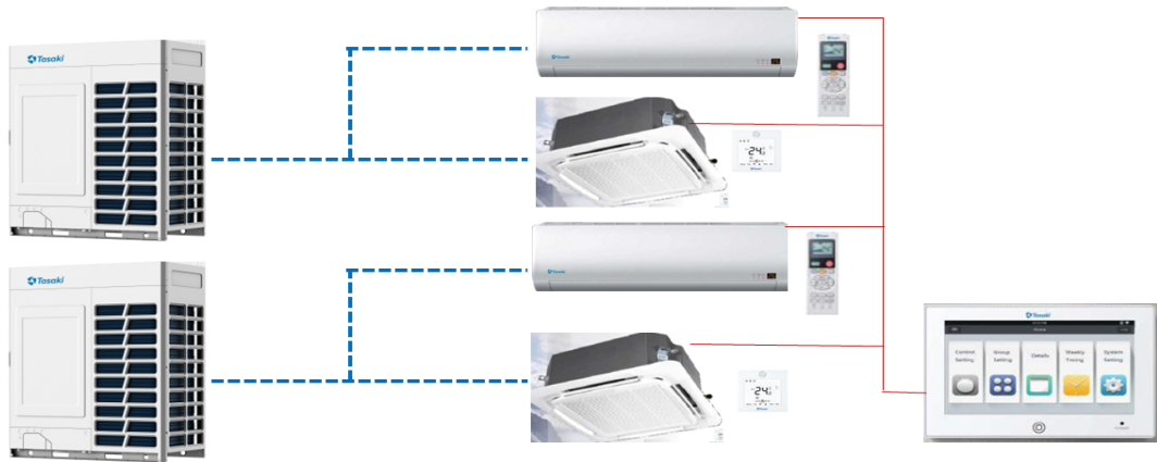
รูปภาพที่ 11 การทำงานของระบบเครื่องปรับอากาศชนิดรวมศูนย์ระบบ VRV
